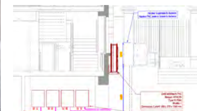
Médiathèque de Fontenay - étude des menuiseries historiques - coupe de principe pour l'installation des PAC
